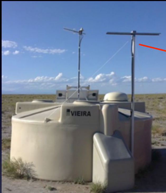
Prototypes MHz installé sur 7 réservoirs
