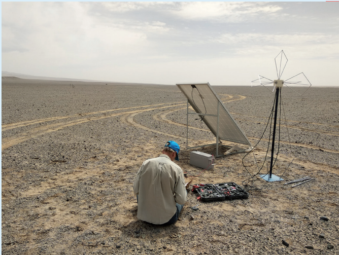
Tests en vue du déploiement de l'expérience GP300 à l'été 2019. Dans la version finale du montage, l'antenne est installée au sommet d'un mat de 3,5m.
