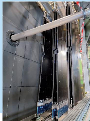
Les modules du détecteur SciFi, en phase de montage dans la cave de l'expérience LHCb. Elle montre six éléments dits « C-Frames » (en 12 couches), et la ligne de tube à vide du LHC.
