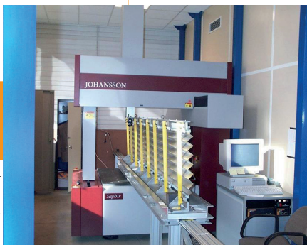
Vue des électrodes en accordéon lors de la construction du calorimètre.
