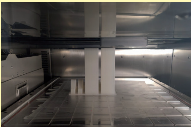
Pièce en cours d'impression dans la nouvelle imprimante 3D multi-matériaux. Elle a été mise en service au début de l'été 2021 après une phase de tests méticuleuse.
