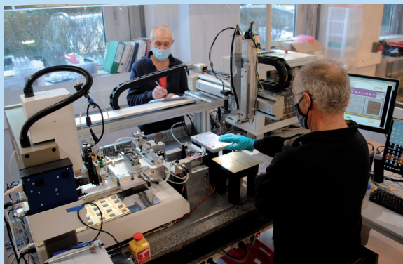
Ensemble du système d'assemblage des plans de détecteur CALICE en cours d'opération. La partie collage et la partie positionnement sont visibles sur la photographie ainsi que la carte électronique COB (Chip on Board) en bas à gauche.
