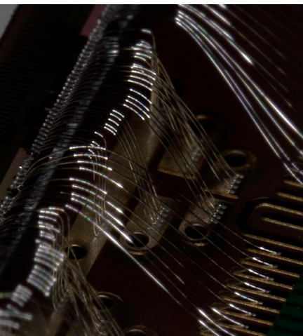
Détail de connexions de quad-module/substrat. Plusieurs types de boucles ont dû être définis.
