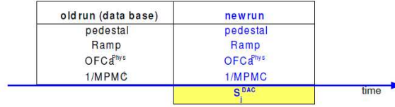
FIGURE 3.9 – Représentation schématique des deux lots de constantes de calibration utilisés dans l'analyse présentée. Les échantillons du signal sont extraits de la nouvelle campagne (new run).
